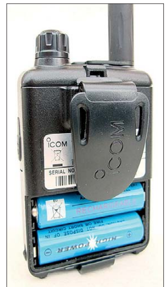
Bild 2: Im Lieferumfang enthalten sind bereits die Akkumulatorzellen, die sich im Gerät laden lassen. Alternativ ist das Gerät mit zwei gewöhnlichen Mignonzellen betreibbar.
