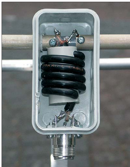
Bild 9: Koaxial-Spisedrossel aus RG58
