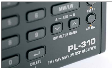
Bild 9: DSP ermöglicht fünf schaltbare AM-Bandbreiten (AM BW). Fotos: DL1ABJ
