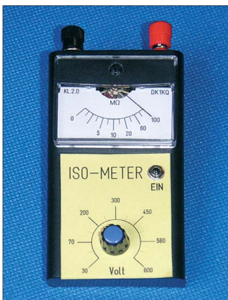
Bild 1: Außenansicht des Isolationsmessgeräts; das Anzeigement wird auf dem Kopf stehend eingebaut.
