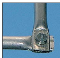
Bild 8: Konstruktion der Eckverbindungen bei 6-mm-Rohren
