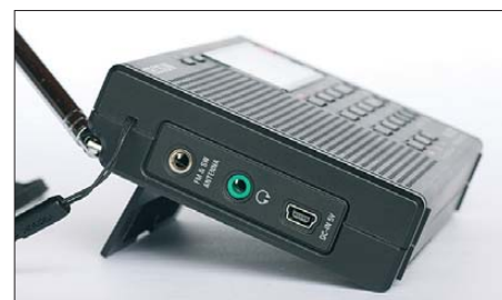
Bild 3: Eine Trageschleife ist fest mit dem Empfänger verbunden. Auf der linken Seite liegen auch die Anschlussbuchsen.
