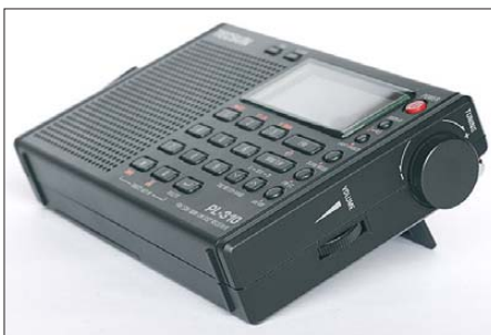
Bild 2: Auf der rechten Gehäusesseite liegen der VFO-Knopf und der Lautstärkesteller, beide mit Rasterung.
