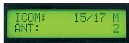
Bild 3: Das Display zeigt den Betriebsmodus, das dekodierte Band und die ausgewählte Antenne. Fotos: DH8BQA
