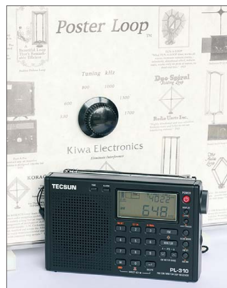
Bild 10: Auch ohne direkten Anschluss bringt eine MW-Rahmenantenne eine deutliche Steigerung der Empfangsqualität.
