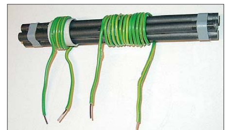
Bild 18: Ferritstabantenne aus mehreren gebündelten dünnen Ferritstäben
