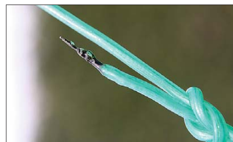
Ergebnis einer Berührung der Metallabspannung mit einem Antennenelement; ob eine Transistorendstufe das überlebt hätte? Die GS35 hat es jedenfalls nicht gestört. Foto: DH7FB
