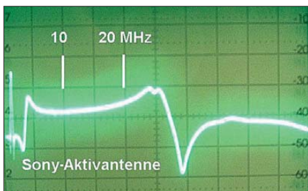
Bild 25: Verstärkung der Aktivantenne von Sony im Bereich von 0...50 MHz; vertikale Auslenkung: 1 Kästchen = 10 dB
