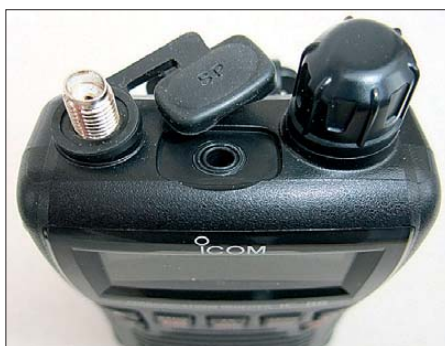
Bild 4: Die Kopfhörerbuchse stellt auch den Anschluss zu einem PC-Interface her. Ein Kopfhörerkabel kann als unauffällige Antenne genutzt werden.
