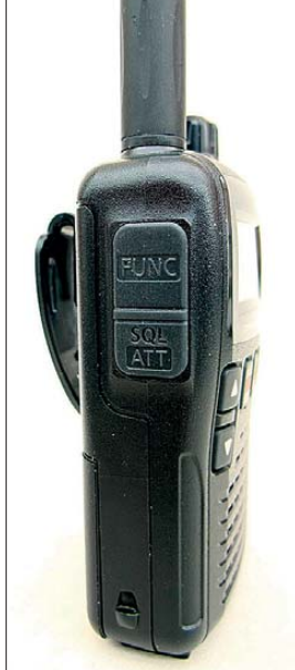
Bild 3: Die linksseitig unter der Zweitfunktions-taste positionierte Monitor-taste schaltet bei Duplex-funktion auch auf die Eingabefrequenz eines Repeaters.
