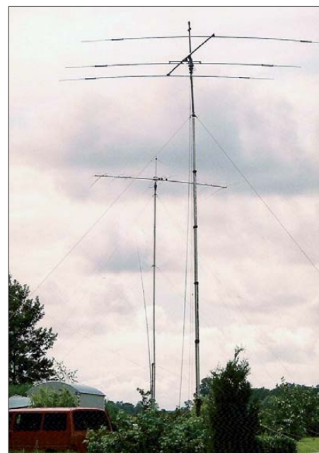
Vorne der Fritzel-Beam, dahinter der JP2000-Beam und die Groundplane für 40 m
